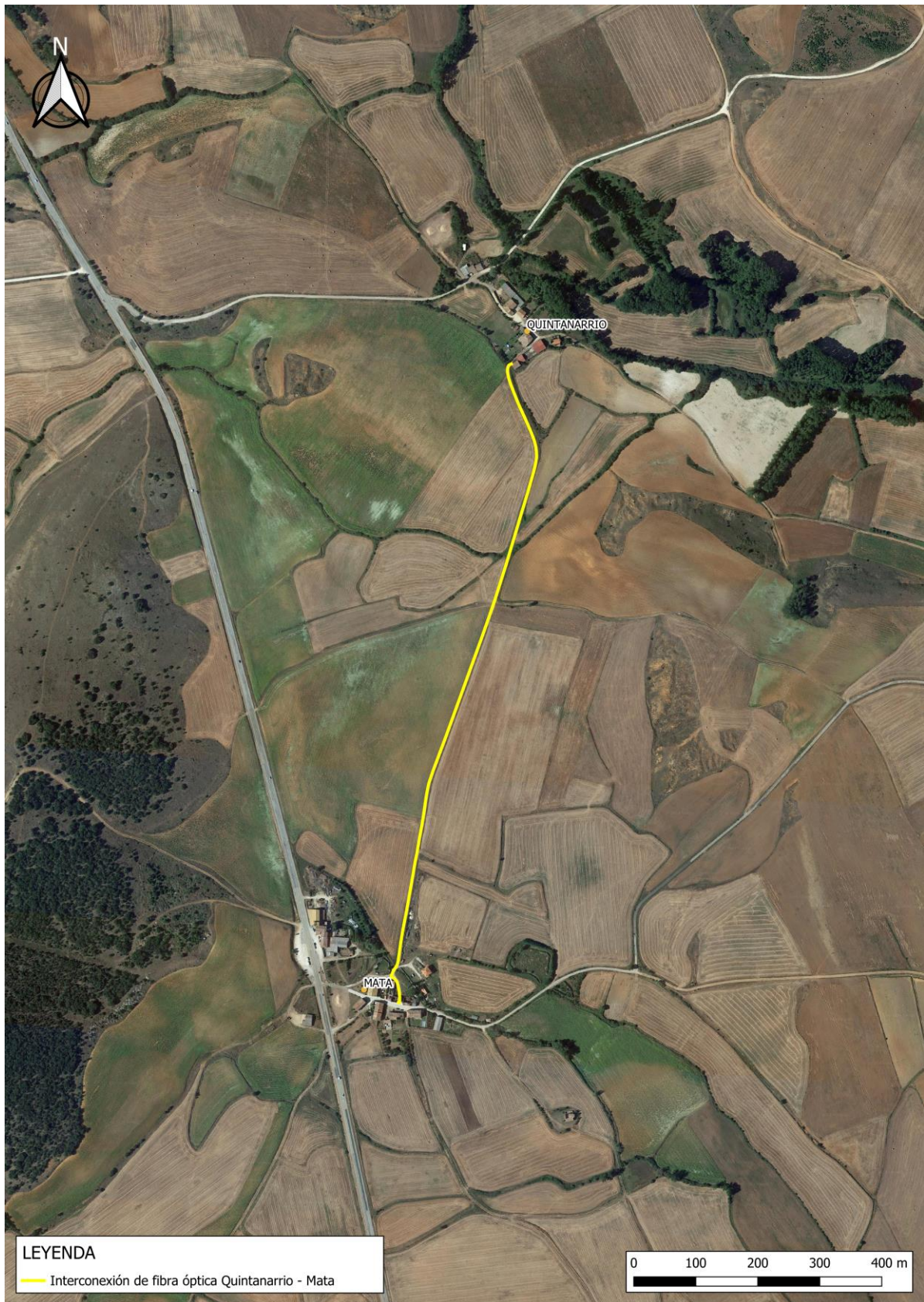
Figura 1. Trazado de la instalación.
